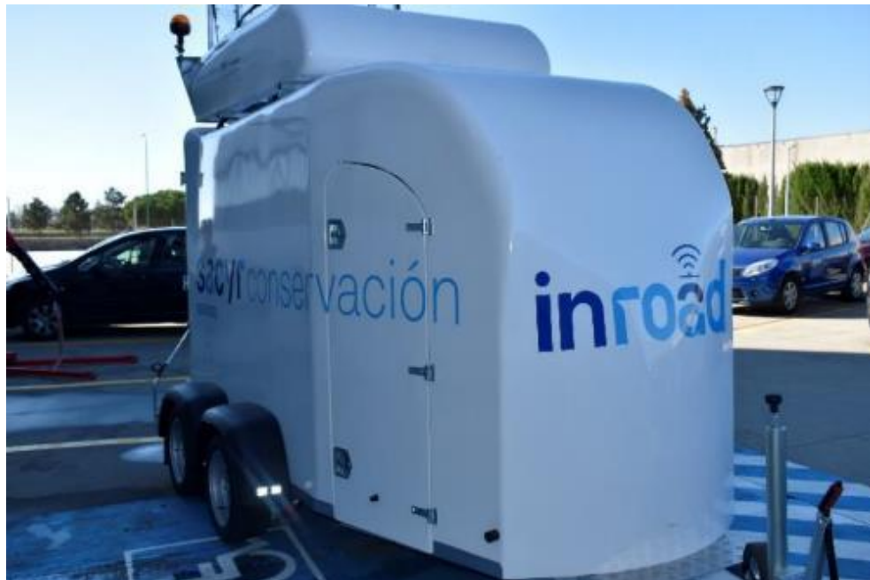
Figura 12. Prototipo de inspección de asfalto desarrollado en el proyecto
