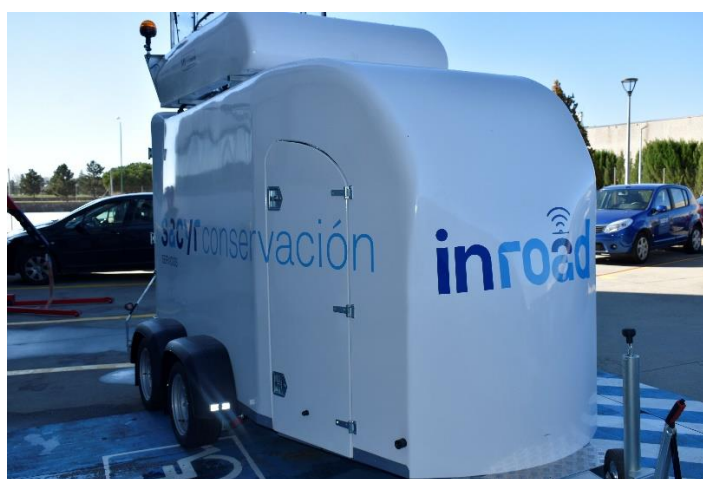
Figura 19. Carro de inspección de asfalto desarrollado en el proyecto
