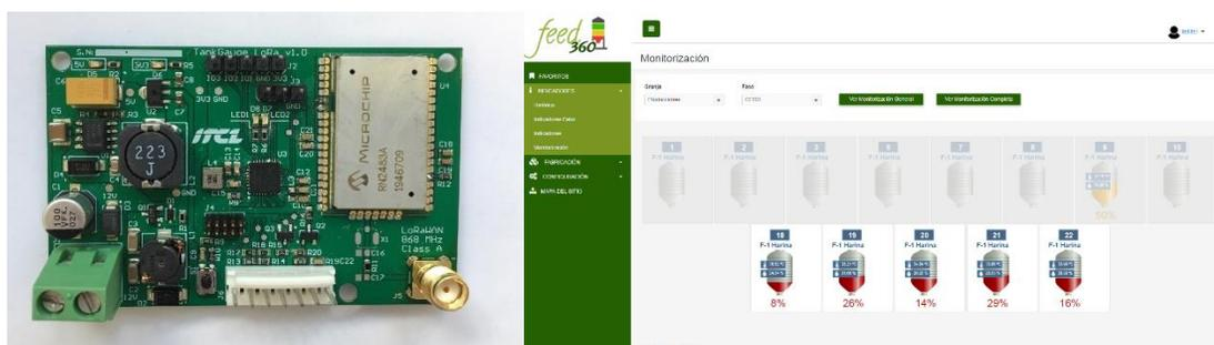
Figura 11. Diseño de placa electrónica de control y Aplicación de gestión de silos
