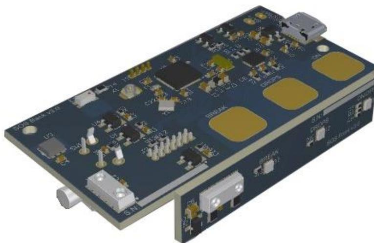
Figura 10. Diseño electrónico del dispositivo
